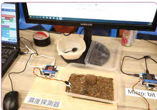
▲ 學生透過應用微型電腦和電子傳感器，製作電子土壤探測及雲端紀錄儀
